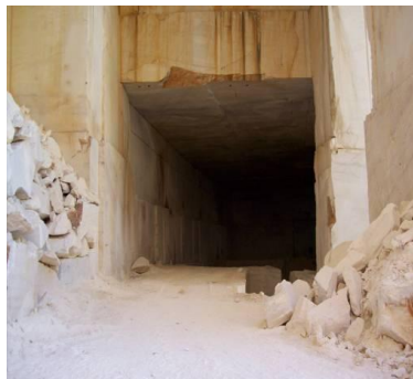
Figura 1: A exploração em galeria é uma das mais recentes inovações na exploração do mármore.
