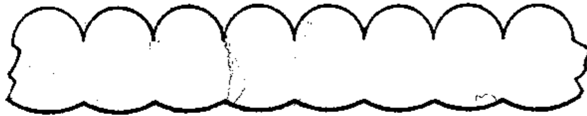
Fig.5 Drawing by G. Lippmann, illustrating a section of the screen. Lippmann, G. (1908). Épreuves réversibles. Photographies intégrales. Comptes rendus , 146
